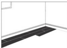
en carton comme guide et utilisez-le pour dessiner un contour sur la planche. Couper à la forme et vérifier qu'il s'adapte. Il doit être bien ajusté et ne doit pas être forcé en place.
